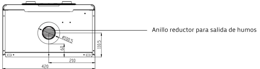
3. Después de la instalación, el tubo de evacuación de humos debe quedar inclinado 2~3 grados hacia abajo para que pueda salir el agua condensada. El espacio entre el tubo de evacuación y el agujero en la pared no se debe rellenar con materiales coagulantes. El tubo de evacuación debe ser fácil de retirar.
